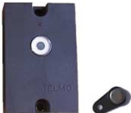
2. ábra. A távolvégi egység és a kódkulcs képe
